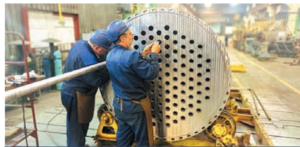
Один из этапов сборки теплообменника – пучкование – для компрессорной станции «Казачья» (Краснодарский край)
