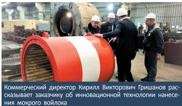
Один из этапов сборки теплообменника – пучкование – для компрессорной станции «Казачья» (Краснодарский край)
