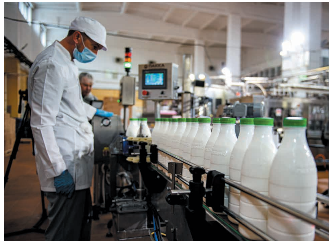
Поддача ПЭТ-бутылки по пластинчатому транспортеру для нанесения этикетки
