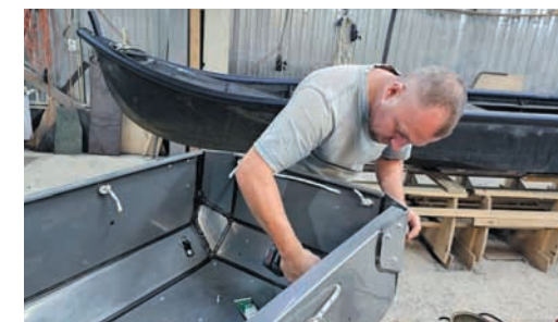
Лодки изготавливаются из полиэтилена низкого давления
